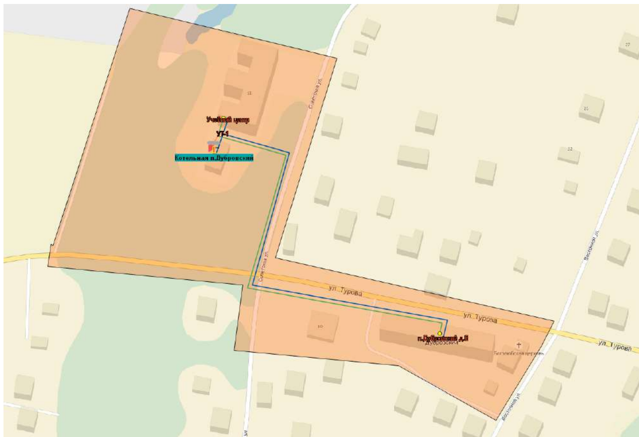
Рисунок 1.10.3.1 – Зона действия источника централизованного горячего водоснабжения котельной учебного центра МОООП «Битца»
