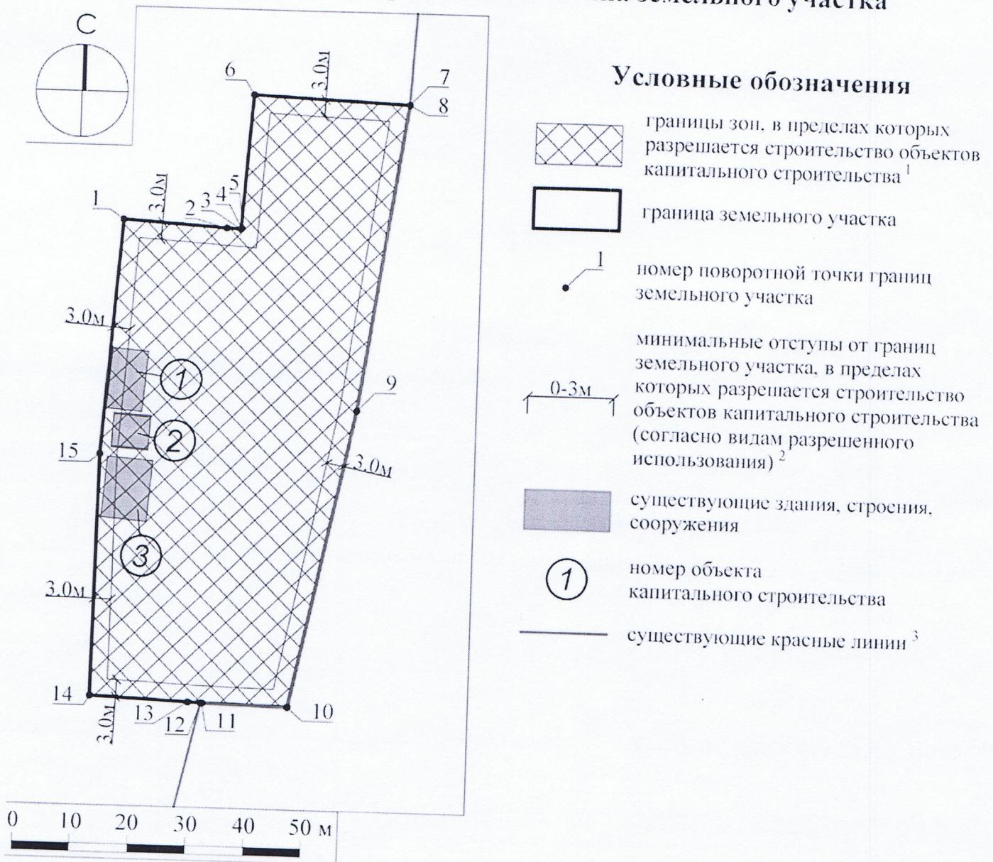
Рисунок 2. Чертеж градостроительного плана рассматриваемого земельного участка
