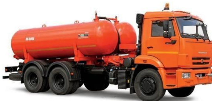
Рис. 5.1. Вакуумная машина КО-505А на шасси КамАЗ-65115-71
