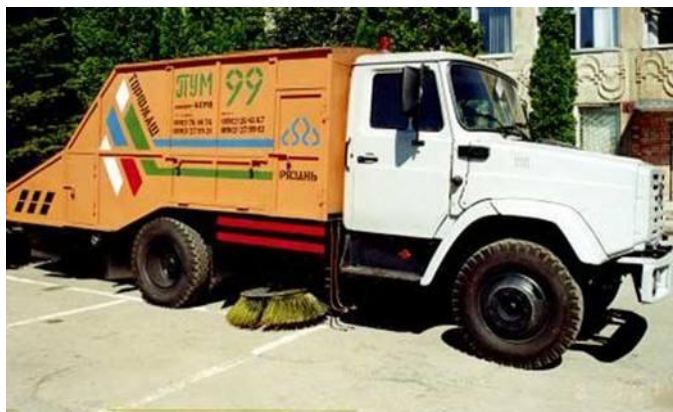
Рис. 6.18. Вакуумная подметально-уборочная машина ПУМ-99 на базе шасси «Зил». Необходимое количество подметально-уборочных машин определяется по формуле:
